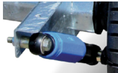
inklusive (Serienausstattung) Radstoßdämpfer für 100 km/h (in DE)
