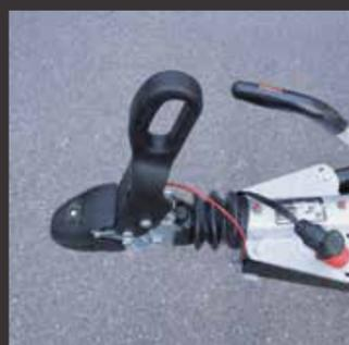
Sicherheitskupplung mit Spurstabilisierung
